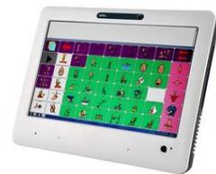
Le « Zingui » est un ordinateur peu puissant, qui ne possède pas de clavier (possibilité d'en connecter un via USB). Il est composé d'un écran tactile très sensible qui réagit aux doigts, d'une coque robuste résistante aux chocs et aux éclaboussures et d'une sortie son améliorée. Le Zingui est un outil idéal pour la communication via synthèse vocale (uniquement).
