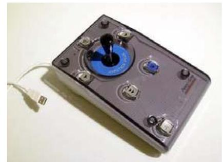
Grâce à un boîtier interface, il est possible d'y brancher un ou plusieurs contacteurs. Il possède un guide-doigts aisément démontable. Pour les gauchers, il est possible d'inverser la touche droite de la souris avec la gauche. Ce modèle USB est compatible avec Windows et Macintosh.
