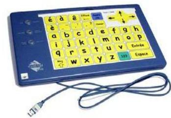
Le clavier Intellikeys est conçu pour les utilisateurs n'ayant pas les capacités pour utiliser un clavier classique d'ordinateur ou une souris standard (handicap moteur, visuel ou cognitif). Ce modèle USB est compatible avec Windows et Macintosh. Une grande incertitude plane sur ce produit quant à sa disponibilité dans l'avenir.
